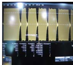
Fig. 9 (d) Type A 100% ASK modulation
